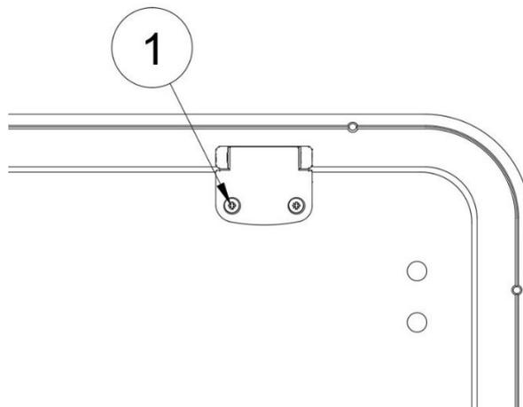
Lors de l'installation d'un Explore Overlander sur une fenêtre coulissante, remplacez la vis supérieure des loquets à ressort par la vis à tête cylindrique M5 x 20 fournie (1). Cette vis est recouverte d'une rondelle (2) et d'un écrou borgne M5 (3).
