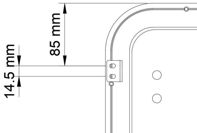
2. Placez les supports de fermeture avec les vis correspondantes sur le cadre de la fenêtre.
