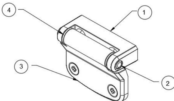
6. Montez les lames de charnière (3x), les loquets à ressort (2x) et les plaques de protection (2x) avec les vis fournies sur l'Overlander.
