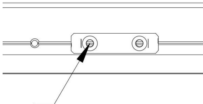
13. Percez ces points avec un foret de 4,2 mm dans le canal de perçage désigné et taraudez ces trous avec un taraud M5. Lubrifiez régulièrement la mèche et le taraud avec de l'huile.
